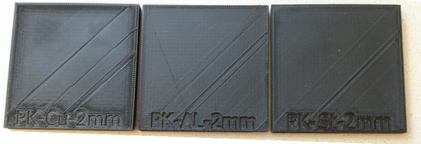
3 Proben mit verschiedenen Inlays (Kupfer, Aluminium, Stahl)
