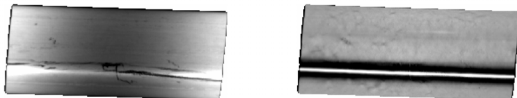
Bild 2: Temperatur- (links) und Phasenbild (rechts) von einem 0.7 mm tiefen Riss.
