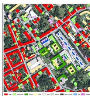
Bild 2: Beispielergebnis aus der Dacheindeckungsklassifikation
