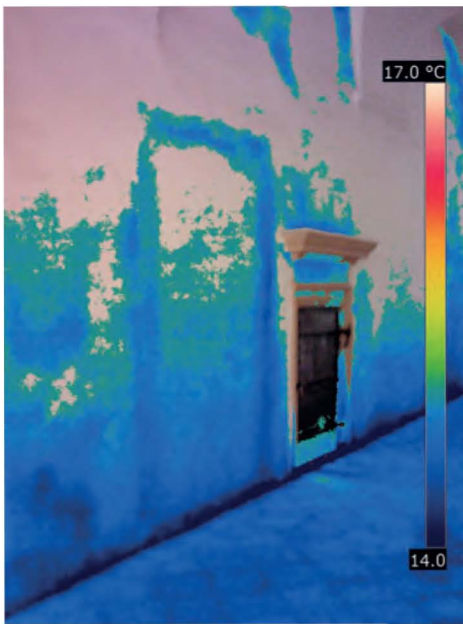
109, 110. Graz, Steiermark, Schloss Eggenberg; links: Wärmestrahlungsbild eines heute vermauerten barocken Türrahmens im Gang des ersten Obergeschosses; rechts: Mittel-turm, das Wärmestrahlungsbild macht die Grenze zwischen mittelalterlichem Mischmauerwerk (blau) und barockem Ziegelverband (grün) sichtbar
