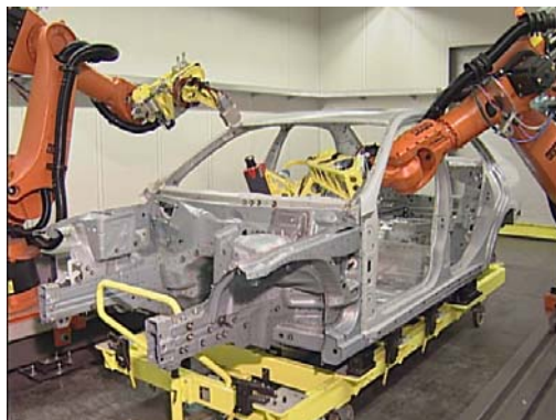
Thermoweld: Vollautomatisches IR-Prüfsystem für Schweißverbindungen im Automobilbau
