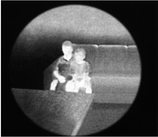
Abb. 12: IR-Aufnahme mit einem Sichtgerät mit pyroelektrischem Vidicon
