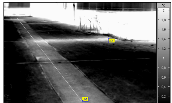
Abb. 28: Thermografiebild Fernwärmeleitung
