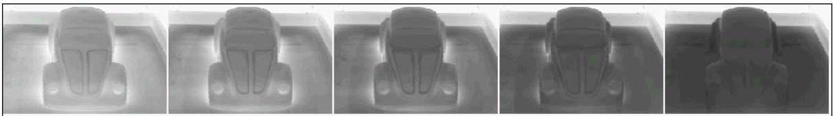
Abb. 34: Tiefziehformteil (Abkühlungsprozess)
