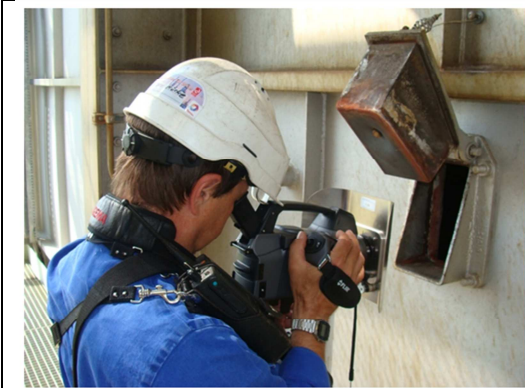
Messung der Rohrwandtemperaturen in einem Raffinerieofen unter Ausblendung der Flammenemissionen (Nutzung eines Durchflammenfilters)
