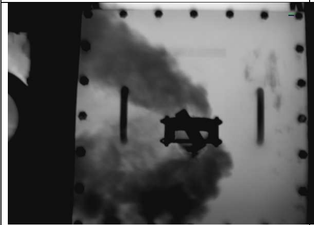
Toluolleckage an einem Extraktor
