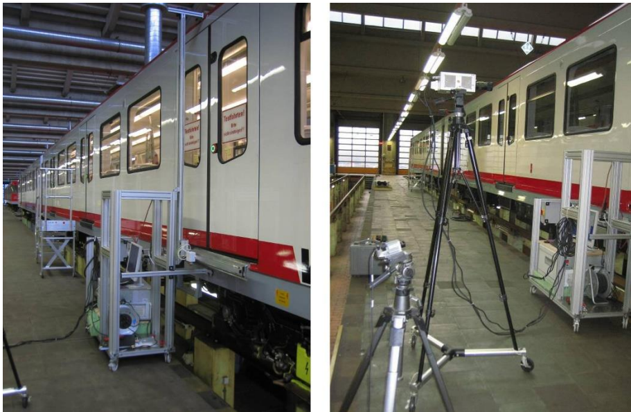
Bild 3: Prüfung von eingebauten U-Bahn-Türen am Bahnsteig
