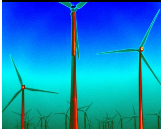
Bild 2: Windkraftpark bei Gols, verschiedene Gondelkonstruktionen führen zu unterschiedlichen Temperaturen am Generator
