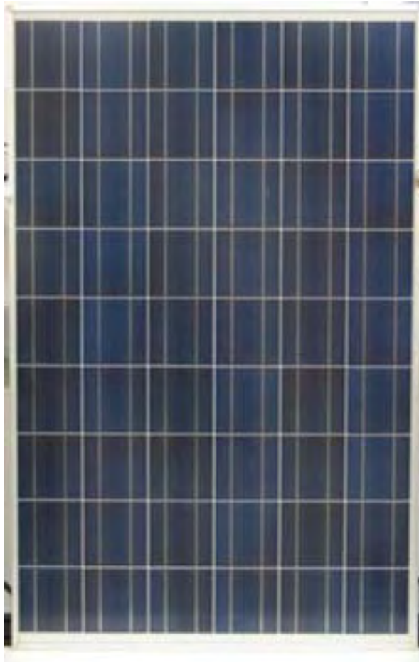
Das PID-Effekt behaftete PV Modul im Labor unter Betrieb in Vorwärtsrichtung
